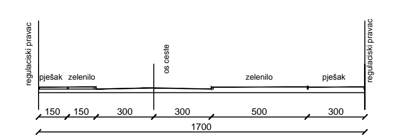
KARAKTERISTIČAN POPREČNI PRESJEK B - B M 1:200
